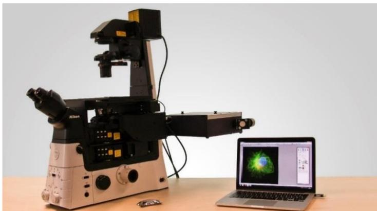
Le projet **REFLECT** porté par Corey Butler et ses associés<sup>1</sup>, consiste à **développer et commercialiser un système de microscopie conçu spécifiquement pour ces cultures tridimensionnelles**. Il s'agit d'un dispositif optique adaptable aux microscopes de laboratoire actuels, couplé à des boîtes de cultures et à un logiciel d'exploitation dédié. **REFLECT rend ainsi la biologie tridimensionnelle rapide et facile d'utilisation.**
